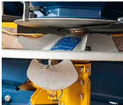
Für die Abdreprobe wird ein Stück der Scheibe entnommen und ein weiteres Blech unter den Auslauf geklemmt. Gleichzeitig dient diese Vorrichtung als Restentleerung.
