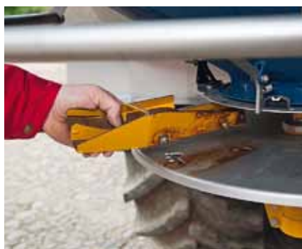
Die Streuflügel lassen sich in mehreren Positionen auf der Scheibe arretieren.
